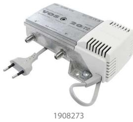
Komplettgerät mit Vorwärts-Verstärker, Rückweg- Verstärker, Rückweg-Filter, Stellgliedern und Netzteil, Gussgehäuse, Interstage-Entzerrer mit Steckbrücken zuschaltbar (6-dB-Preemphase), für Innenmontage
